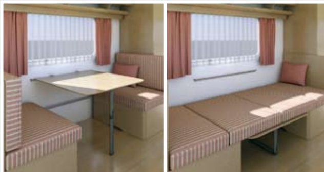
Tischgleitschiene und Stützfüße – praktisch und sicher
